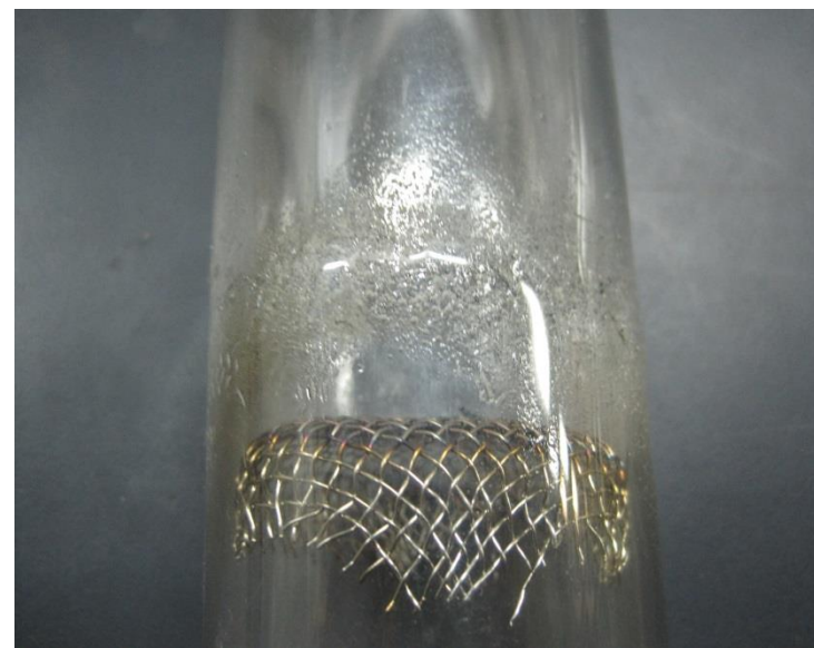
アクリル管の溶融部 (ステンレス収納部)
